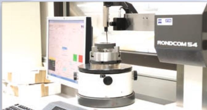
Messung der Formtoleranzen an Einstellringen
