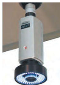
QVP (Quick Vision Probe - Kamerová snímací sonda)
