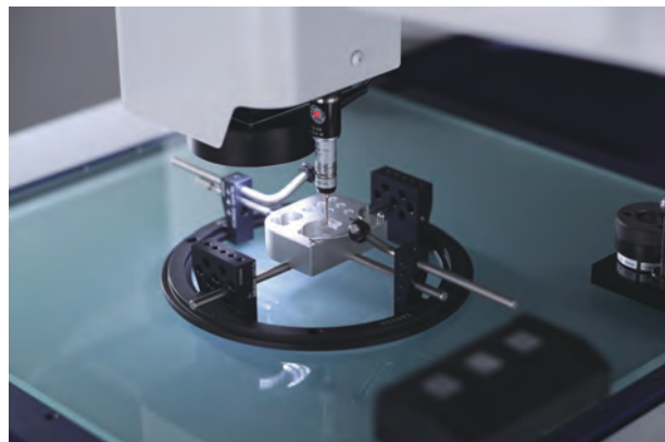
Quick Vision ACTIVE s volitelnou dotykovou sondou
