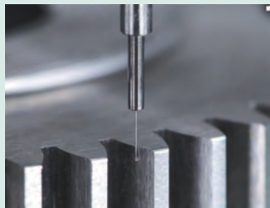
Měření ozubení pomocí MPP-Nano Modul 0,8
